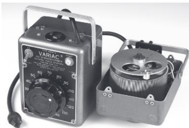
1.129-rasm. Avtotransformator ("Variac") siz sinaydigan elektron qurilmaga as tarmoq man-baidan beriladigan kuchlanish qiymatini o'zgartirishga imkon beradi. Ko'rsatilgan qobig'i yopiq va ochiq avtotransformatorlar 5 amperga mo'ljallangan.
