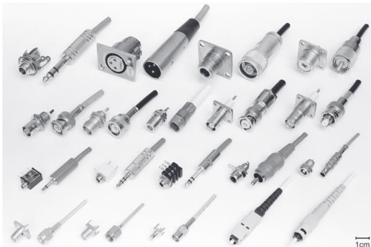
1.125-rasm. Radiochastotali va ekranlangan konnektorlar. Panelga o‘rnatiladigan qismlari kabelga o‘rnatiladigan qismlarining chap tomonida joylashtirilgan. YUqori qator chapdan o‘ngga: stereo tovush konnektori, audio “XLR”type; N va UHF(RF)konnektorlar. Ikkinchi qator: BNC TNC type F; MHVva SHV(yuqori voltli). Uchinchi qator: 2mm (3/32”) audio, 3.5mm stereo, mukammallashtirilgan 3.5mm stereo, fono (“RCAtype”), LEMO koaksial. Quyi qator: (panel, egiluvchan koaksial konnektor), SMA (panel, qattiq koaksial konnektor), SMB; SC va ST (optik konnektor).
