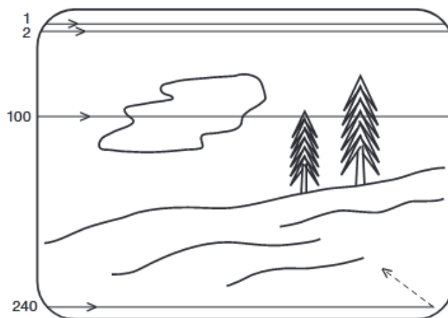
I.1-rasm. Statik ikki o‘lchamli tasvir “rastr bo‘yicha skanerlanib” video signal yaratiladi (I.2-rasm). Video signal harakat yo‘nalishidagi tasvir elementlarining yorug‘ligiga proporsional bo‘lgan elektr kuchlanishlardan iborat bo‘ladi.
